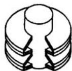
Ресор с подредени дискове (в разрез)
