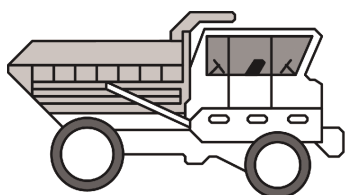
Prekucnik z dvosmernim sedežem in dvosmernim upravljanjem
