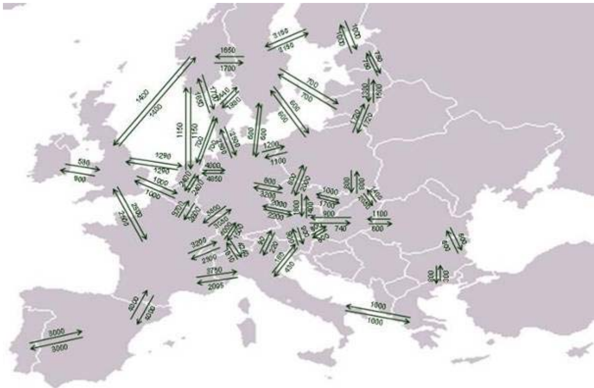
Mapa 6: Požadavky na kapacitu propojení v roce 2020 v MW 47 , referenční scénář modelu PRIMES (zdroj: KEMA, Imperial College London)
