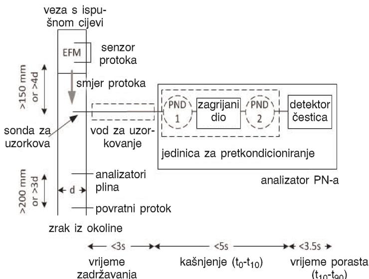
Analizator PN-a spaja se s točkom uzorkovanja sondom za uzorkovanje kojom se izdvaja uzorak iz središnjeg pravca ispušne cijevi. Kako je utvrđeno u točki 3.5. Dodatka 1., ako se čestice ne razrjeđuju u ispušnoj cijevi, vod za uzorkovanje mora biti zagrijan na temperaturu od najmanje 373 K (100 °C) do točke prvog razrjeđivanja u analizatoru PN-a ili detektoru čestica tog analizatora. Vrijeme zadržavanja uzorka u vodu za uzorkovanje mora biti kraće od 3 sekunde.
