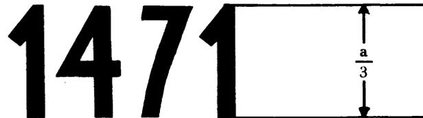
Eine Einrichtung mit diesem EWG-Genehmigungszeichen ist eine Bremsleuchte, für die im Vereinigten Königreich (e 11) unter der Nr. 1471 eine EWG-Bauartgenehmigung erteilt wurde.
