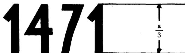
Eine Einrichtung mit diesem EWG-Genehmigungszeichen ist eine Schlußleuchte, für die im Vereinigten Königreich (e 11) unter der Nummer 1471 eine EWG-Bauartgenehmigung erteilt wurde. Das Fehlen eines Pfeils weist darauf hin, daß die geforderten photometrischen Werte nach rechts und links bis zu einem horizontalen Winkel von  $80^\circ$  H erreicht werden.
