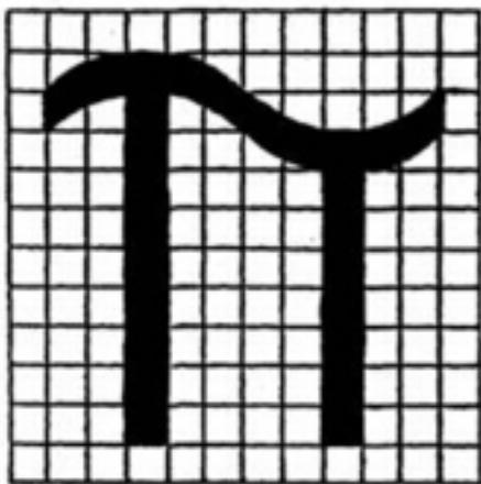
2. Минималната височина на маркировката „Pi“ е 5 mm. При транспортируемо оборудване под налягане с диаметър, равен или по-малък от 140 mm, минималната височина е 2,5 mm.
