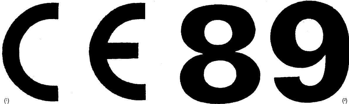
Вертикалните размери на различните компоненти на EO маркировката трябва да бъдат еднакви и не по-малки от 5 mm.
