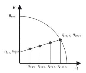
7. Eine Einstellung der Pumpe wählen, bei der der Punkt  $Q_{100\,\%}$ ,  $H_{100\,\%}$  erreicht wird. Bei in Produkte integrierten Umwälzpumpen der Bezugskurve folgen und dazu die Anlagenkennlinie und die Drehzahl der Umwälzpumpe anpassen.
