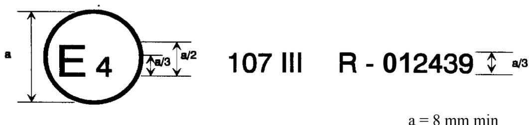
La marque d'homologation ci-dessus, apposée sur un véhicule, indique que le type de ce véhicule a été, en ce qui concerne ses caractéristiques de construction, homologué aux Pays-Bas (E4) pour la classe III, en application du Règlement n° 107, sous le numéro 012439. Ce numéro indique que l'homologation a été délivrée conformément aux prescriptions du Règlement n° 107 tel que modifié par la série 01 d'amendements.
