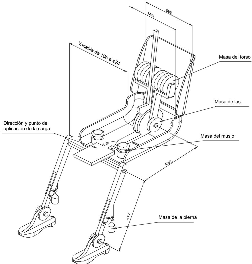
Figura 2 — Dimensiones de los elementos del maniquí 3-D H y distribución de la carga (dimensiones en milímetros)
