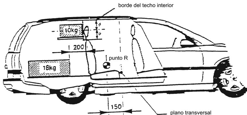
Figura 2 — Ensayo de un sistema de separación situado por encima del respaldo
