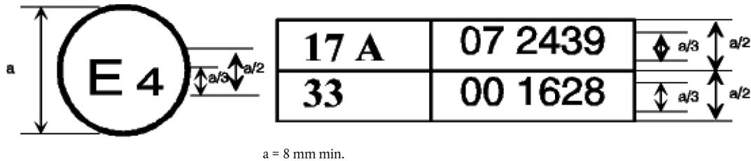
Esta marca de homologación colocada en un vehículo indica que el tipo de vehículo tiene como mínimo un asiento equipado o que puede ser equipado con apoyacabezas y que ha sido homologado en los Países Bajos (E4), de conformidad con los Reglamentos n° 17 y n° 33 <sup>(1)</sup>.
