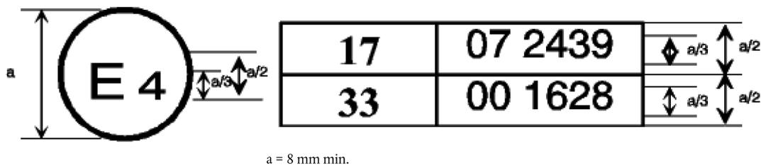
Esta marca de homologación colocada en un vehículo indica que el tipo de vehículo tiene asientos no equipados o que no pueden ser equipados con apoyacabezas y que ha sido homologado en los Países Bajos (E4), de conformidad con los Reglamentos n° 17 y n° 33 <sup>(1)</sup>. Los números de homologación indican que, en las fechas en que se concedió la homologación, el Reglamento n° 17 incluía la serie 07 de enmiendas, pero el Reglamento n° 33 aún se mantenía en su forma original.
