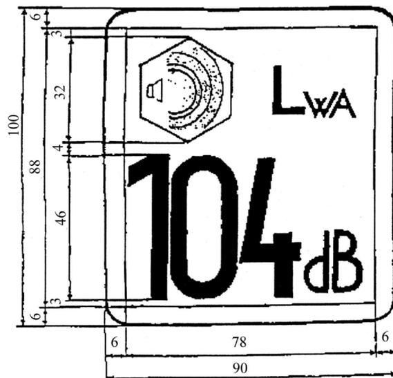
Si l'indication est réduite ou agrandie en fonction de la taille de l'équipement, les proportions indiquées dans le dessin figurant ci-dessus doivent être respectées. Toutefois, la dimension verticale de l'indication ne devrait pas, si possible, être inférieure à 40 mm.
