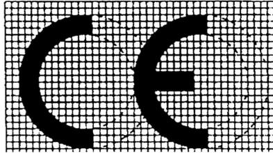
Si le marquage «CE» est réduit ou agrandi en fonction de la taille du matériel, les proportions données par le schéma figurant ci-dessous doivent être respectées. Les divers éléments du marquage «CE» doivent avoir fondamentalement la même hauteur, qui ne doit pas être inférieure à 5 mm.
