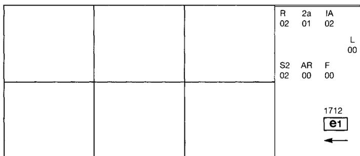
*Anmerkung:* Die drei Beispiele von Typgenehmigungszeichen, Muster A, B und C, stellen drei mögliche Varianten für die Kennzeichnung einer Beleuchtungs- oder Lichtsignaleinrichtung dar, in der zwei oder mehrere Leuchten Teil der gleichen Baugruppe von zusammengebauten, kombinierten oder ineinandergebauten Leuchten sind. Dieses Typgenehmigungszeichen gibt an, daß die Einrichtung in Deutschland (e1) unter der Grund-Typgenehmigungsnummer 1712 genehmigt wurde und folgendes umfaßt:
