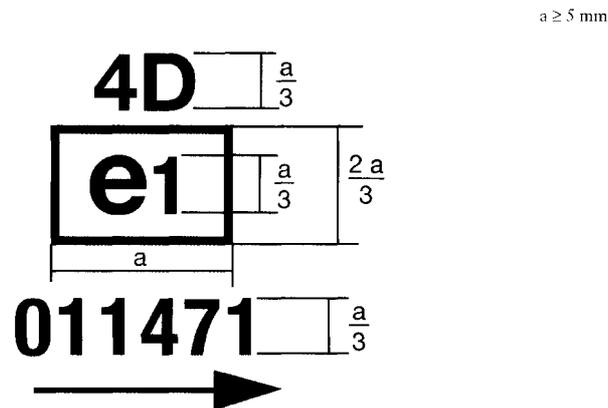
Die Einrichtung mit dem dargestellten EG-Bauteil-Typgenehmigungszeichen ist eine Fahrtrichtungsanzeigerleuchte der Kategorie 4, für die die Typgenehmigung gemäß dieser Richtlinie (01) in Deutschland (e1) unter der Grundgenehmigungsnummer 1471 erteilt wurde und die auch in einer Baugruppe von zwei Leuchten verwendet werden kann. Der Pfeil weist in Fahrtrichtung.
