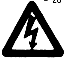
Gevaar voor elektrische spanning
