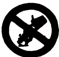
Verboden met water te blussen
